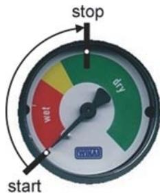
Перед контролем мощности необходимо компрессор выключить сетевым выключателем, выпустить давление воздуха из ресивера и отсоединить выходной шланг от быстросоединительного элемента OUT (10). Потом включить компрессор сетевым выключателем и измерить временной интервал между точками старт - стоп. Мощность компрессора соответствует, если измеренный временной интервал не более, чем 45 сек для DK50 D или 30 сек для DK50 DM.
