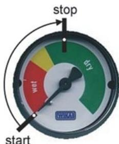
Pred kontrolou výkonnosti je potrebné kompresor vypnúť sieťovým vypínačom, vypustiť tlak vzduchu vo vzdušníku na nulu a odpojiť výstupnú hadicu z rýchlospojky OUT (10). Potom zapnúť kompresor sieťovým vypínačom a merať čas medzi bodmi start - stop. Výkonnosť kompresora vyhovuje, ak nameraný čas nie je vyšší ako 45 s pre DK50 D alebo 30 s pre DK50 DM.
